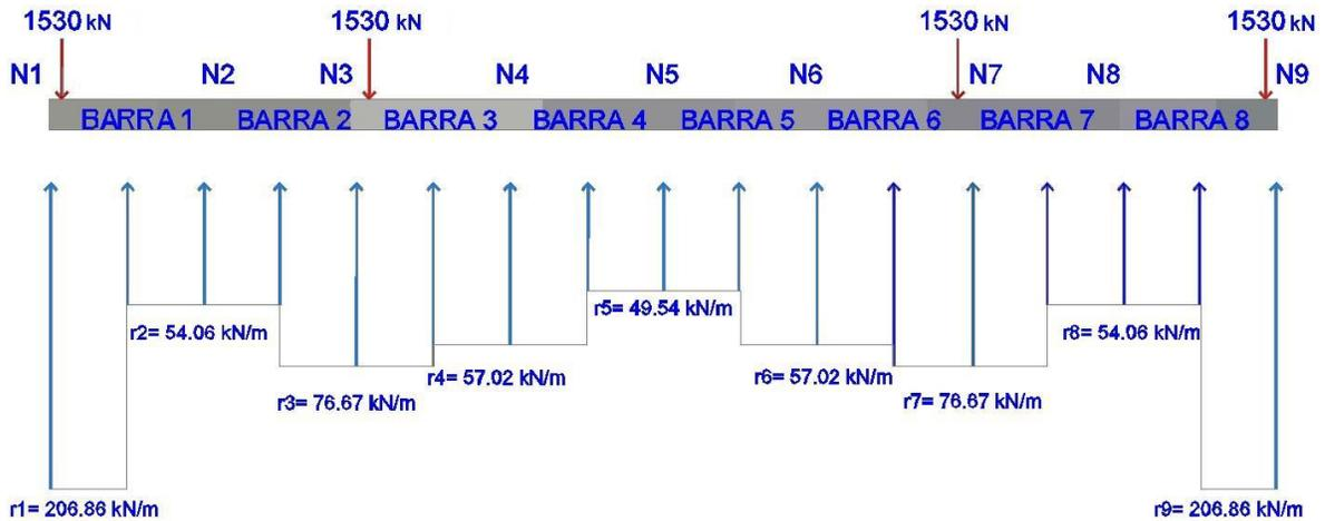
Figura III.12. Diagrama de reacciones en el suelo a lo largo del eje de la retícula, sin expansiones.
