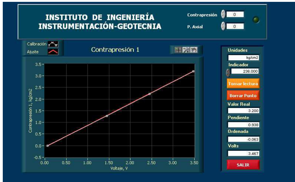
Figura 3.15 Ventanas de calibración del transductor de contrapresión.
