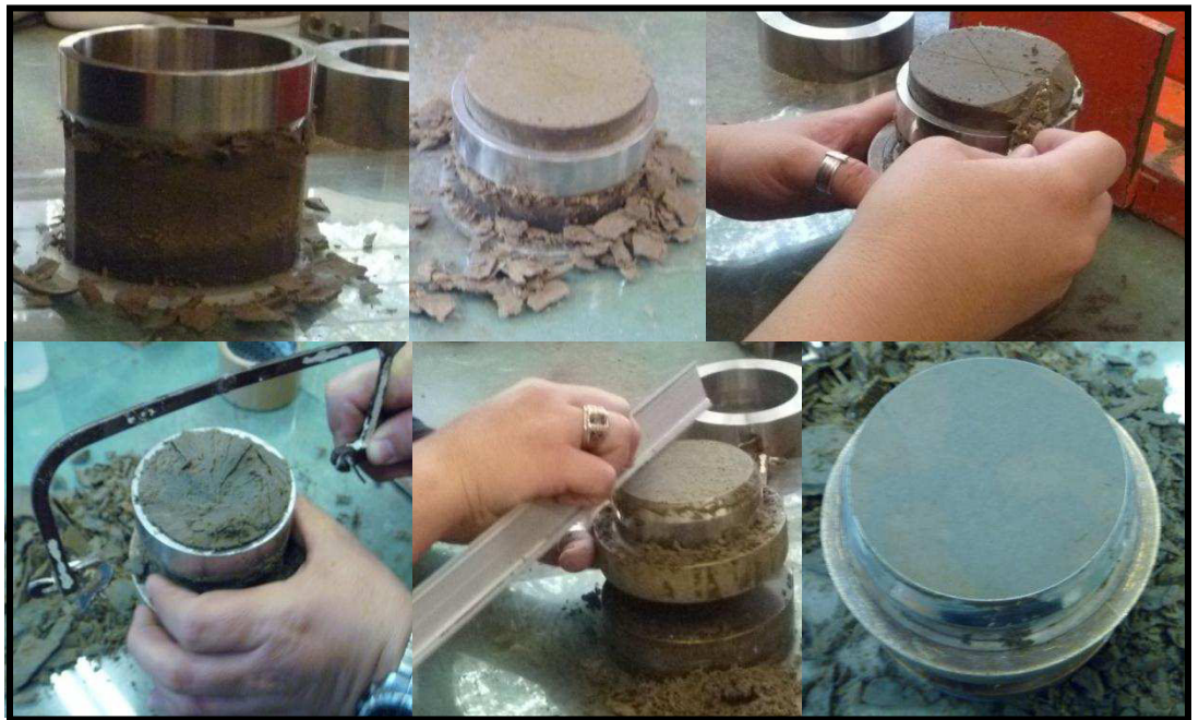
Figura A.5 Proceso de labrado de la pastilla de suelo.
