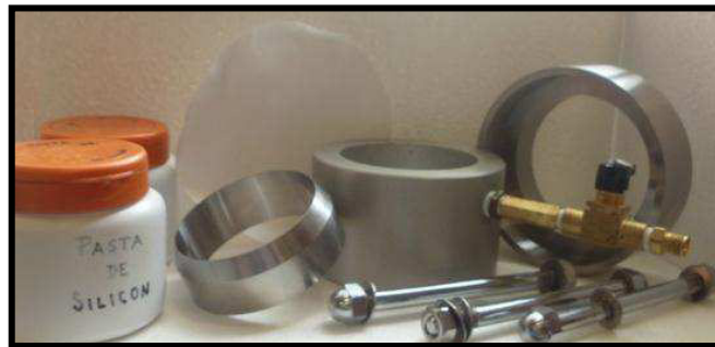
Figura A.6 Elementos necesarios para el montaje de la probeta de suelo.
