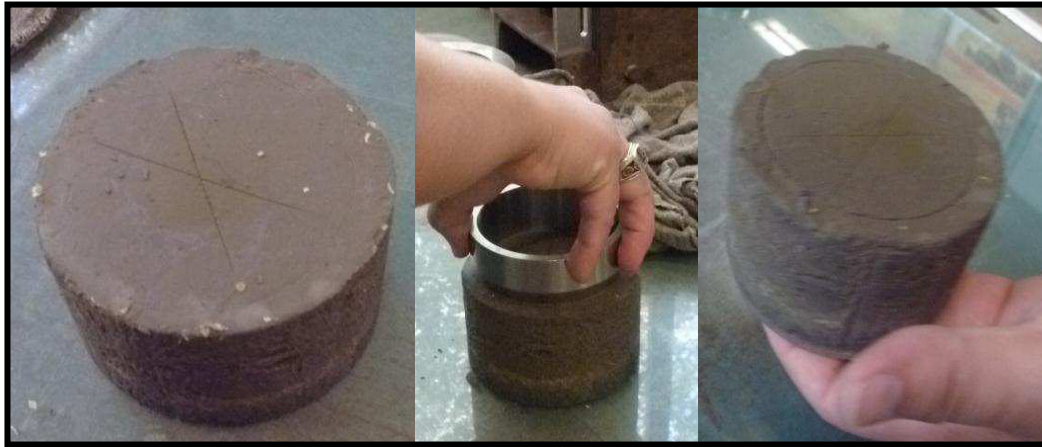
Figura A.3 Establecimiento del diámetro en la muestra usando el anillo metálico, para su corte y labrado.
