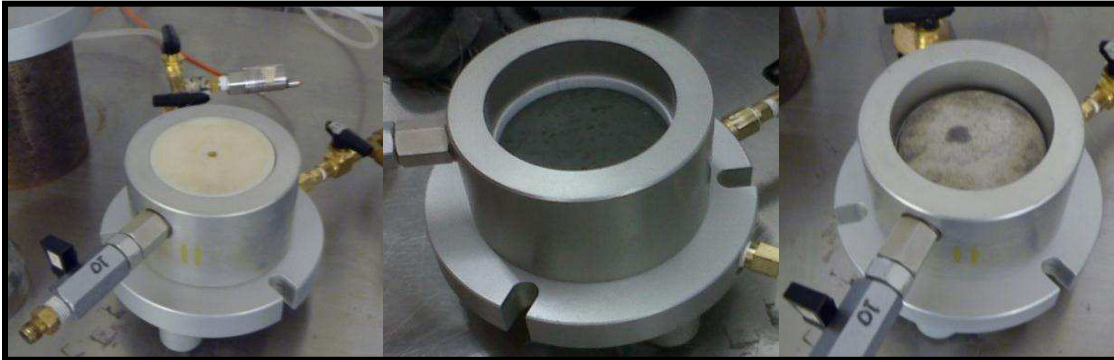
Figura A.9 Colocación de base y cuerpo de la celda Rowe.
