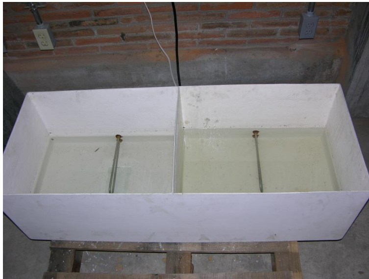
Figura 32. Baño María en el que se colocarán los reactores
