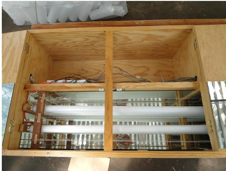
Figura 17. Cámara de radiación UV. Se pueden observar las lámparas y los espejos.
