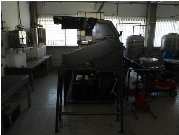
Figura 24. Trituradora industrial en el laboratorio de Ingeniería Sanitaria
