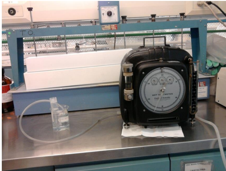
Figura 36. Flujómetro para realizar pruebas de desplazamiento de volumen.
