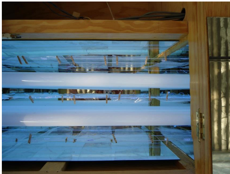
Figura 20. . Películas de polietileno en presencia de radiación UV y sostenidas mediante ganchos de madera.
