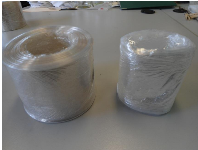
Figura 12. Películas de polietileno con aditivo de estearato (izquierda) de cobalto y sin aditivo (derecha).
