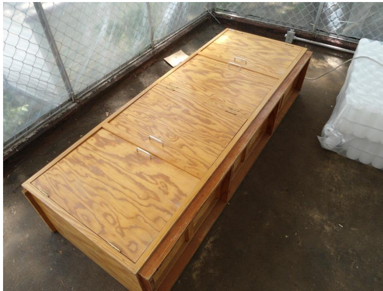
Figura 16. Mueble utilizado para construir la cámara de radiación UV.
