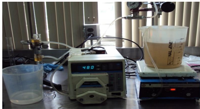
Figura 6. 20 Proceso de ultrafiltración con un módulo de membrana externa.
