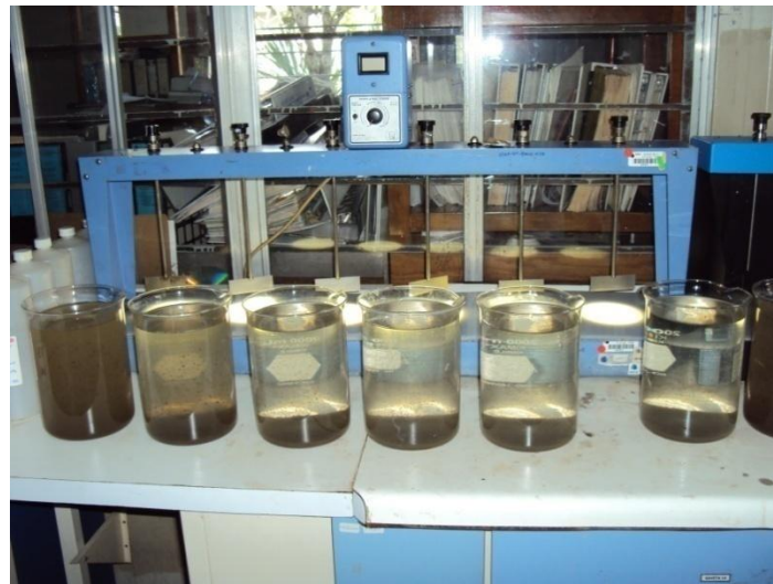
Figura 5. 2 Desestabilización de la emulsión aplicando PIX 111.
