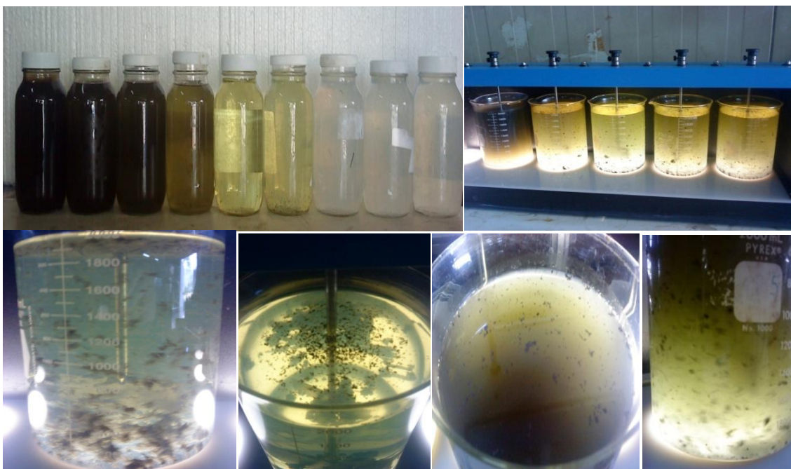
Figura 5. 8 Rompimiento de la emulsión y formación del floc con la aplicación de floculante LACKFLOC-C-5100 (fotografía izquierda) y otros coagulantes y floculantes (fotografía derecha).
