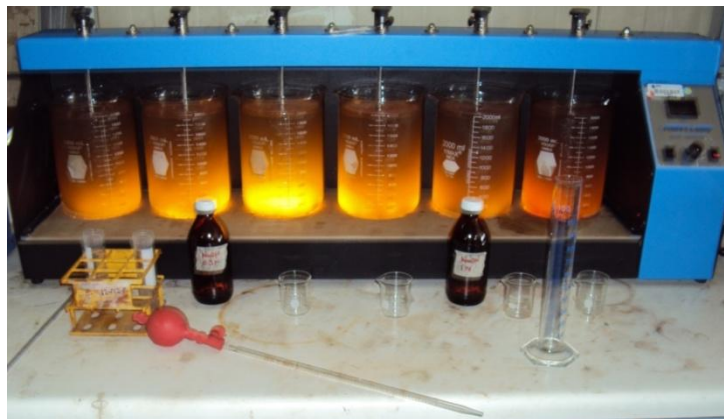
Figura 4. 1 Equipo Phipps & Bird para la prueba de jarras.
