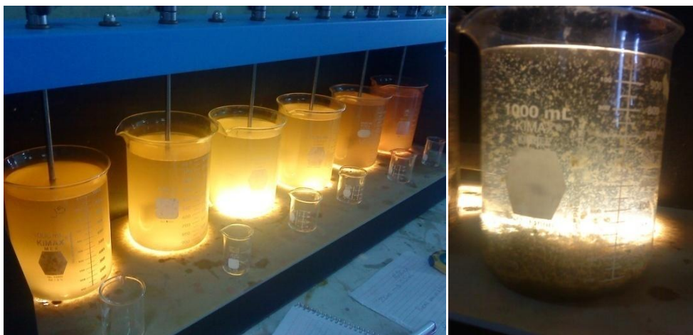
Figura 5. 1 Desestabilización de la emulsión aplicando Sulfato de Aluminio.
