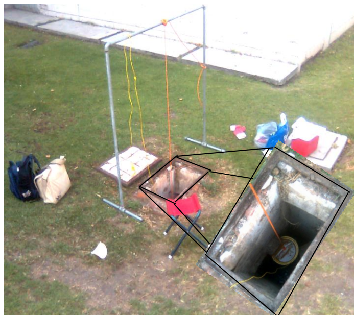
Figura A1-3. Mecanismo de aforo y muestreo
