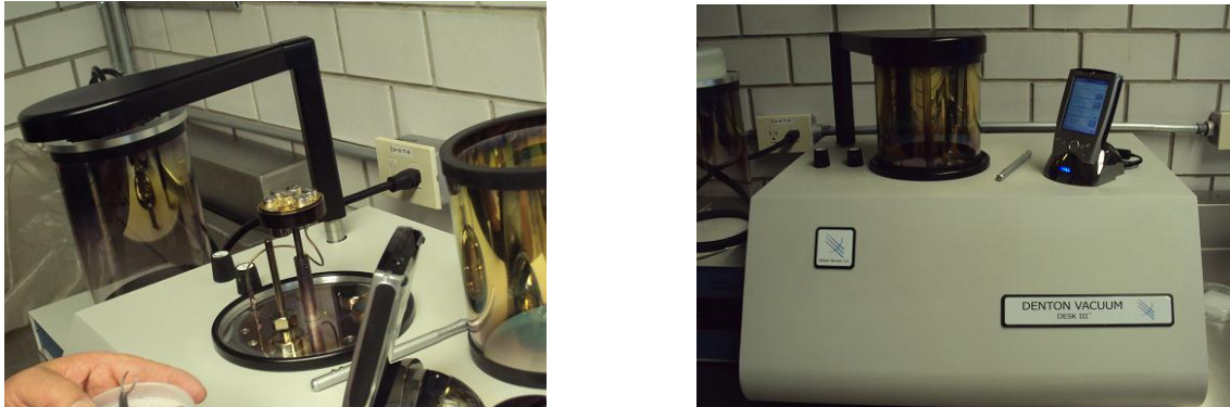
Figura IV-11. Recubrimiento de las muestras en bajo vacío utilizando oro (sputtering)
