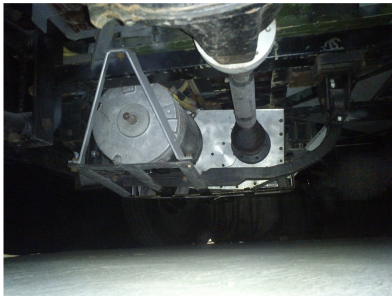
Figura 2.9 Reductor montado en el vehículo.
