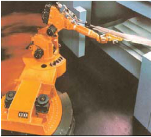
Figura 1.8. Robótica: operaciones de precisión, con inercia reducida gran rigidez y gran capacidad de sobrecarga.
