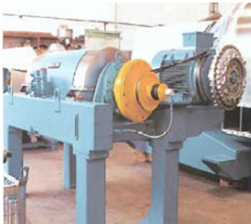
Figura 1.7. Centrifugadoras de separación sólido-líquido: amplia gama para adaptarse a la aplicación concreta (tipo de árbol de salida, velocidades, par de salida, etc.)
