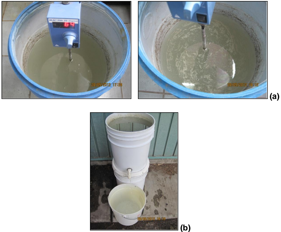
Figura 3.4 Pretratamiento del agua desflepada: a) coagulación-floculación y b) filtración
