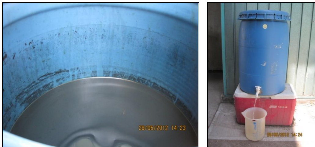
Figura 3.3 Separación por gravedad de grasas y aceites
