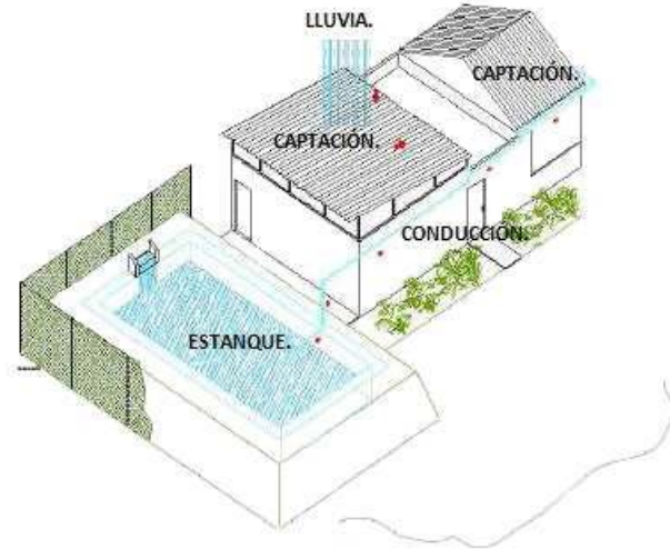
Figura 7. Sistema de captación Colpos 2.
