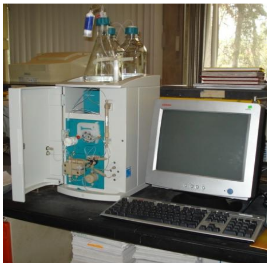
Figura 25 Equipo de cromatografía del laboratorio de contaminación ambiental del Centro de Ciencias de la Atmósfera, en donde se lleva a cabo el análisis de las muestras HPLC .
