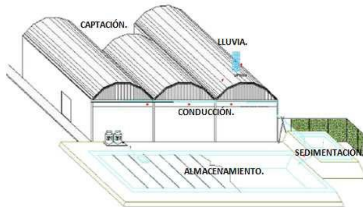
Figura 8. Sistema de captación Colpos 3.
