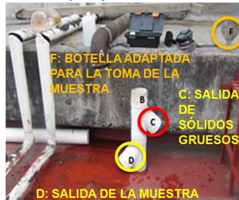
Figura 27 Adaptación realizada para la toma de muestras de agua de lluvia.
