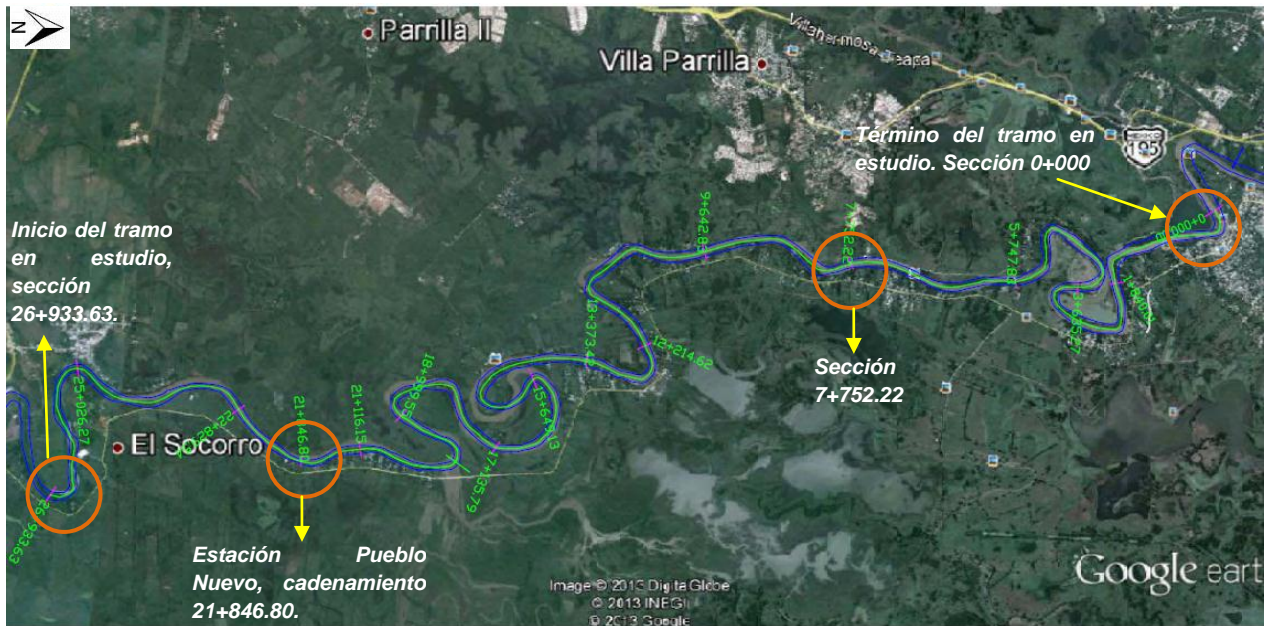
Figura 7. Planta del río de la Sierra del tramo en estudio y distribución de las secciones transversales del río de la Sierra. Fuente Google Earth.
