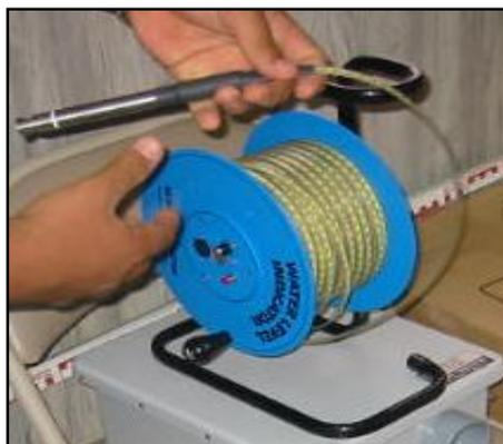
**Foto 4a.** Sonda Piezométrica.
