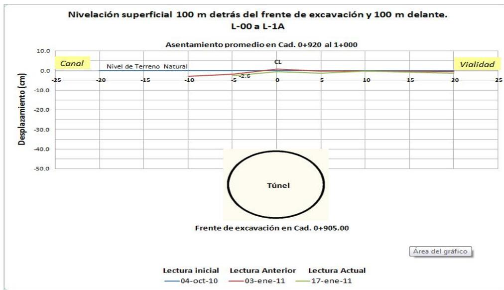
Figura 18. Gráfica secciones de nivelación en el trazo del túnel.
