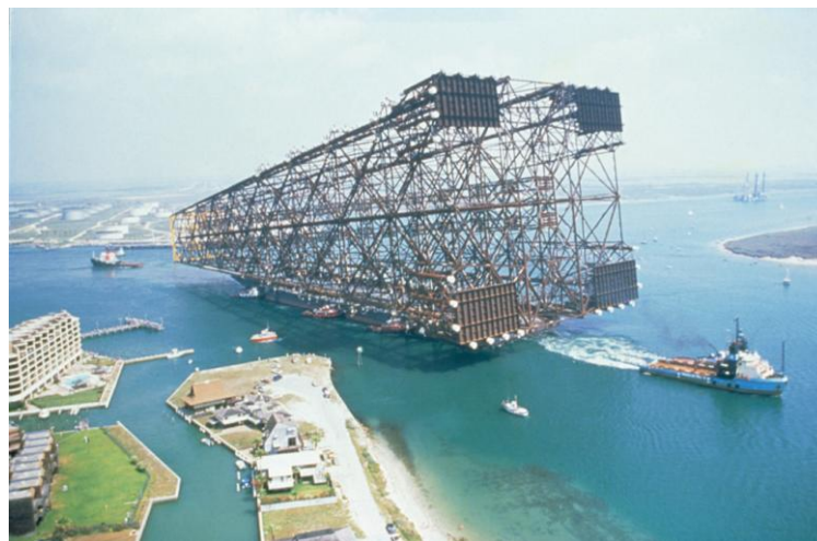
Fig. 2.3.6.-Transportación de Jacket a alta mar.
