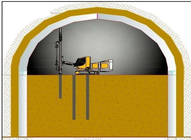
Figura 4.14: Barrenación Vertical con Hidrotrack en Media Sección Inferior
