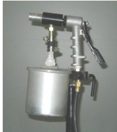
Figura 1.12 Granalladora con sistema de succión que se utiliza en este trabajo.
