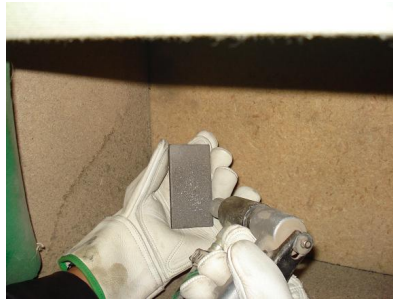
Figura 2. Proceso de granallado
