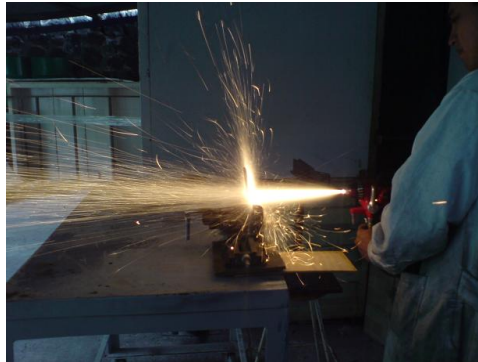
Figura 7. Proceso de proyección térmica con alimentación de alambre.
