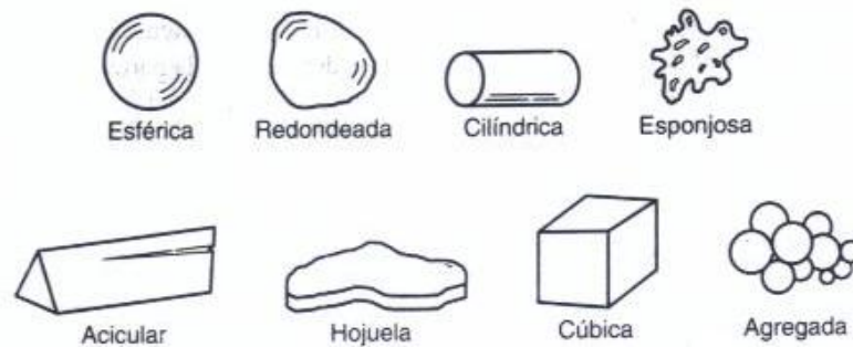
Figura 1.6 Varias formas de partículas en metalurgia de polvos. 4
