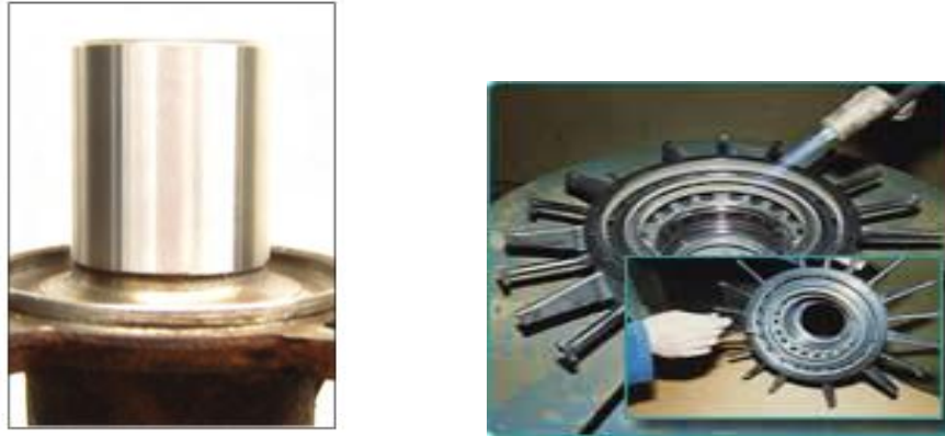
Figura 2.9 Rociado térmico de elementos mecánicos
