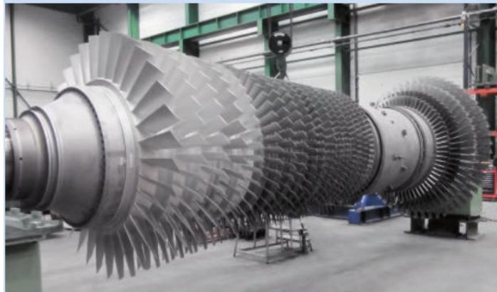
Figura 2.11 Aplicación de rociado térmico en turbinas 11
