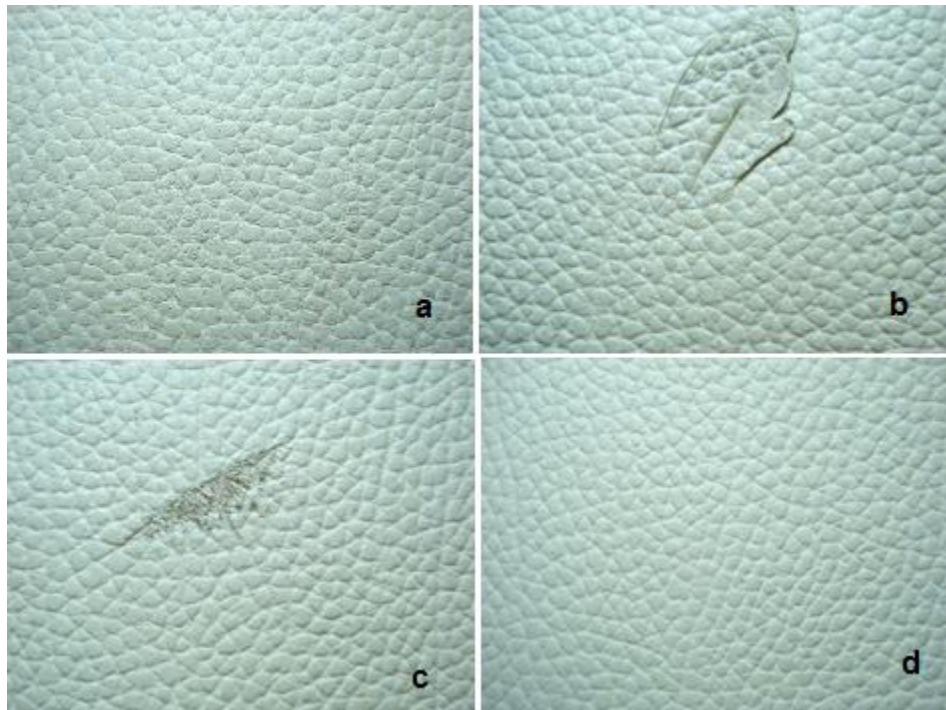
Figura 5 Imágenes adquiridas con la fuente de luz seleccionada, matriz (6x4) de leds de luz blanca. a) Imagen de piel con porosidades b) Imagen de piel con desgarrre c) Imagen de piel con rasgadura d) Imagen de piel sin defecto
