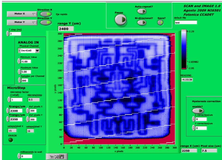
**Figura 5.14b** Imagen con  $\mu$ -ondas. El área explorada es de  $(2300 \times 2350) \mu\text{m}^2$ , el número de pixeles es 300 x 300 y el tiempo que llevó la obtención de esta imagen fue de 690 minutos. ( $7.1 \mu\text{m} / \text{pixel}$ ) en X; ( $8 \mu\text{m} / \text{pixel}$ ) en Y.
