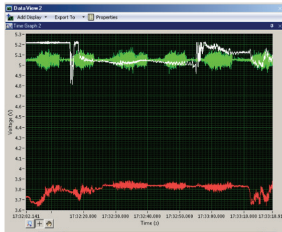
Imagen 46. La línea blanca representa la variación de voltaje dependiente del sensor de fuerza. Hay una caída de 0.2 Volts en esta muestra.
