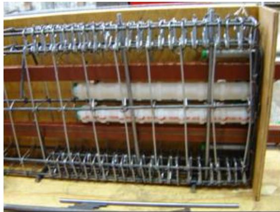
(d) Detalle de ductos en la base
