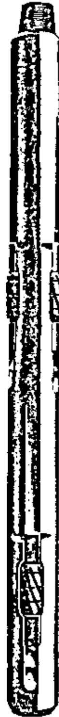
Fig. 3-17.— Escariador representativo de "tres puntos" dobles para barrena. El escariador de este tipo se corre entre los lastrabarrenas y la barrena, como sucede con el diseño de "tres puntos", pero se usa donde se requiere más estabilización o mayor capacidad de escariado.
