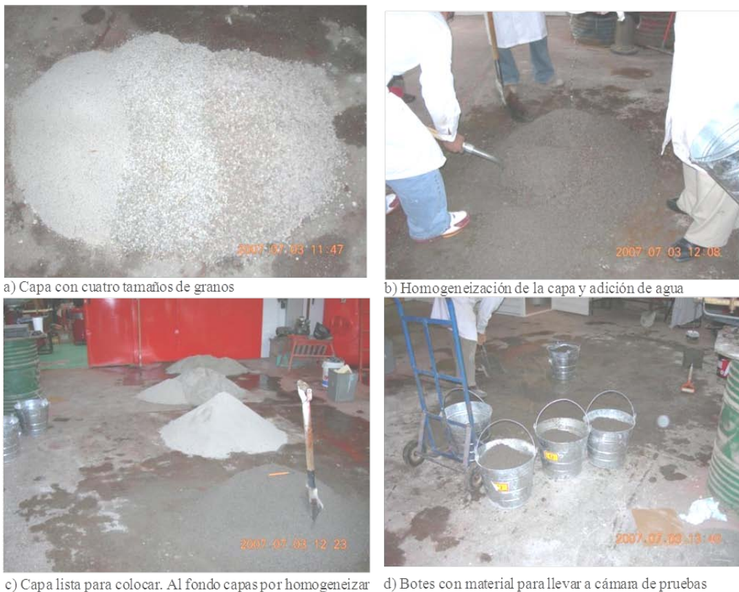
Figura 3.4 Formación de capas de suelo para compactar dentro de cubo de pruebas
