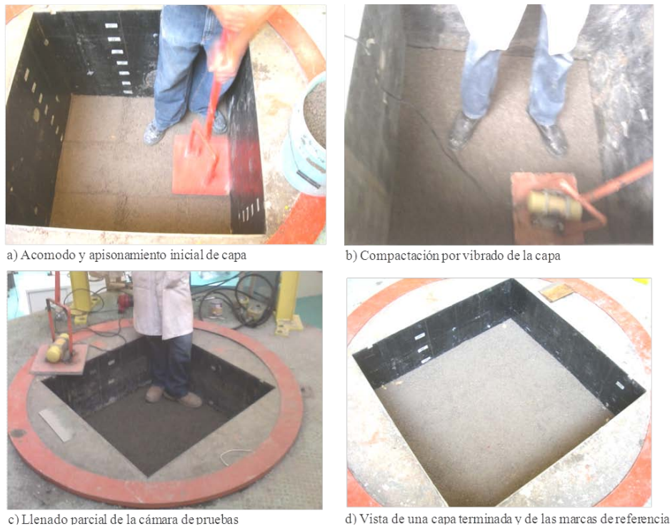
Figura 3.5 Colocación y compactación del material dentro del cubo de pruebas
