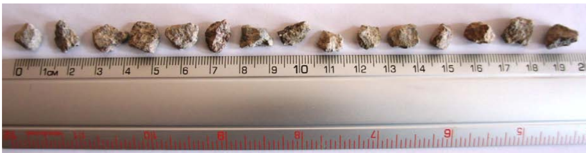
Figura 3.14 Forma de las partículas de grava empleadas en los ensayos
