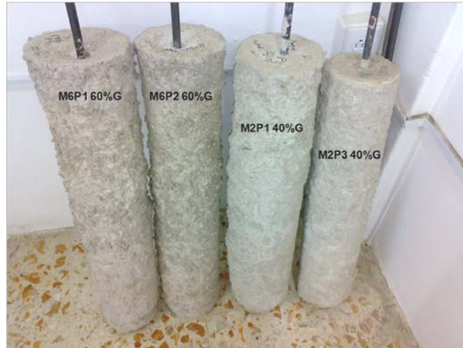
Figura 4.5 Modelos de pilas después de la excavación (series M2 y M6)
