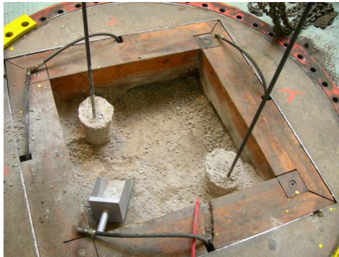
Figura 4.4 Excavación alrededor de los modelos de pilas. Serie M1
