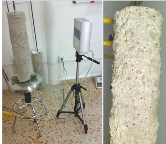
Figura 4.6 Arreglo para realizar el escaneo tridimensional láser
