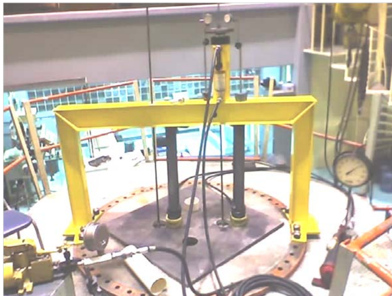
Figura 3.11 Esquemas y vista del marco de carga para la aplicación de cargas de extracción y presión vertical externa
