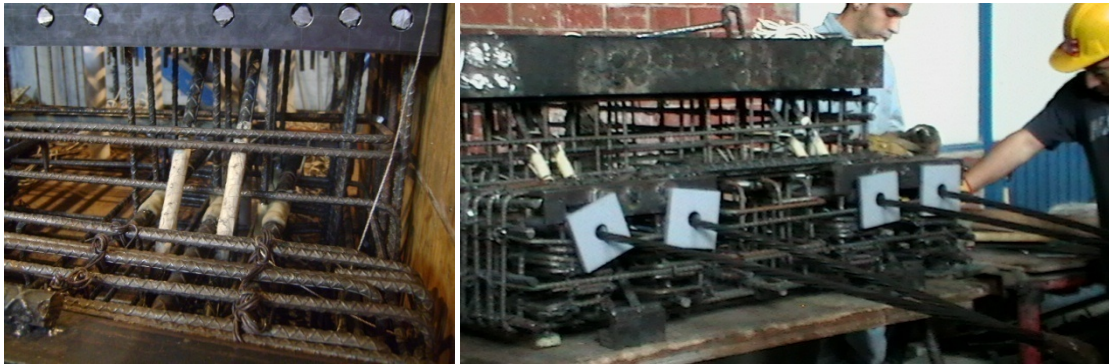
Figura 20 Espécimen E4 y su refuerzo
