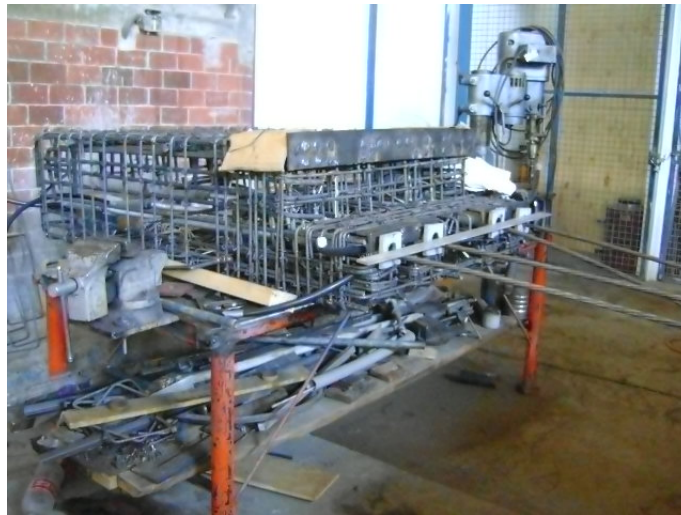
Figura 18 Especímen E2 y su refuerzo
