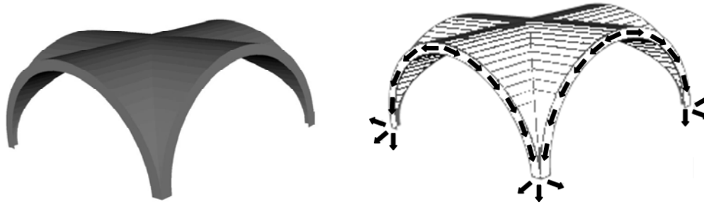
Figura 2.9. Esquema de una bóveda de arista y su transmisión de cargas
