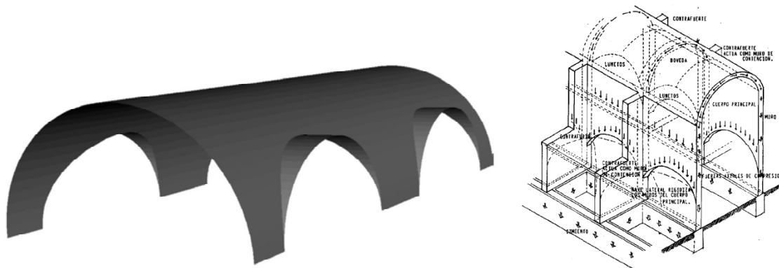
Figura 2.8. Esquema de una bóveda de lunetos y su forma de transmitir las cargas
