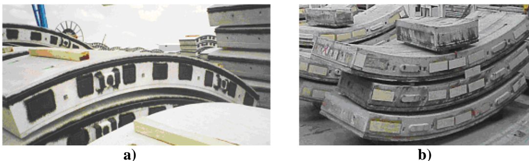
Figura 4. Dovelas prefabricadas, con material de empaque en sus juntas entre anillos Lutikholt (2007): a) plástico (“Kaubit”); b) madera contra chapada (“Plywood”)
