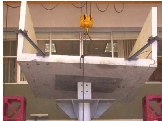
(b) Ensamble de caja de concreto
