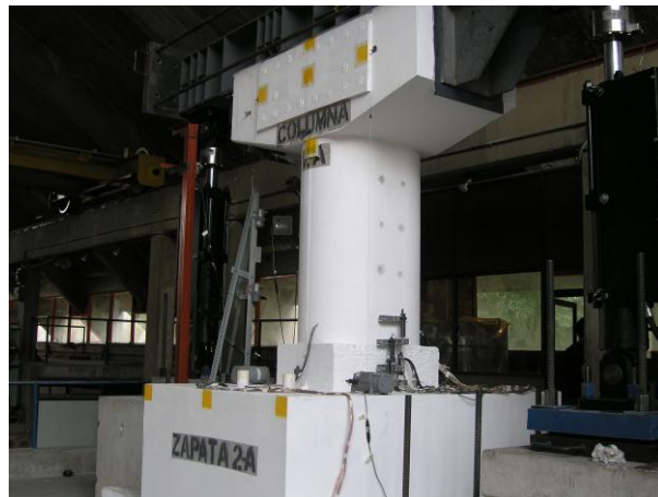
Figura 3.19 Espécimen 2-A al inicio de la prueba
