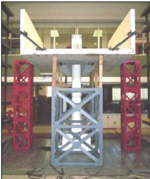
(a) Apuntalamiento de la caja
