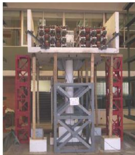
(b) Apuntalamiento final de la caja
