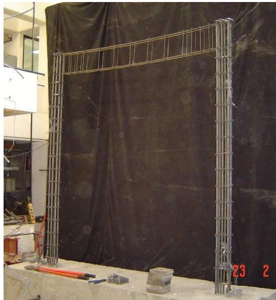
**Figura L.7 a) Armado de los muros sin refuerzo en el alma (MCNOM, MCCOM)**
