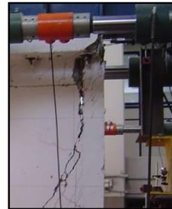
**Figura S.16 Evolución del agrietamiento durante el ensaye MCA0M**
