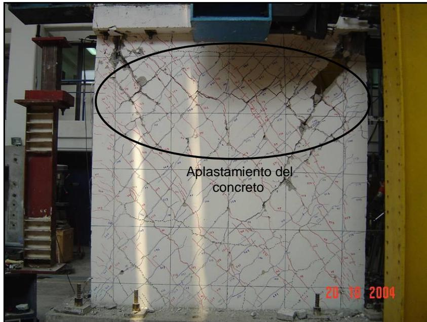
**Figura S.31 Estado final de daño del muro MCA100C**
