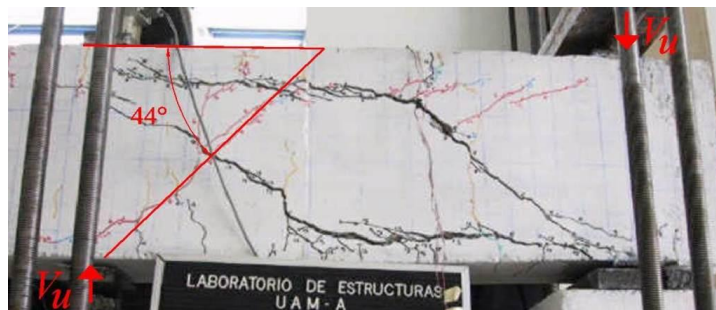
c) grieta crítica carga antigravitacional
