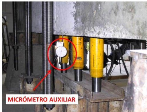
c) micrómetro correctivo en la trabe de reacción
