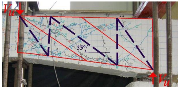
c) modelo de armadura carga gravitacional
