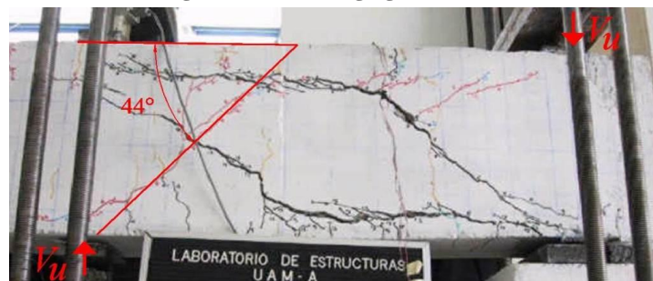
c) grieta crítica carga antigravitacional
