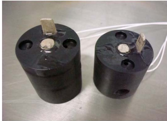
Figura A. 6 Arreglo final de los cristales en el pedestal y cabezal de una cámara triaxial
