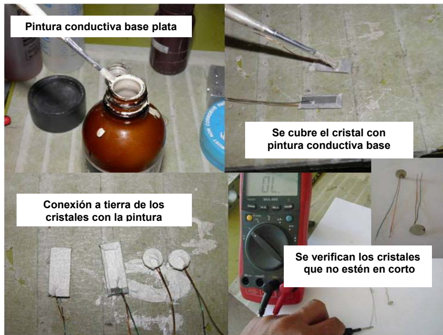
Figura 3. 16 Conexión a tierra de los cristales piezoeléctricos
