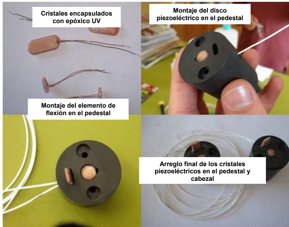
Figura 3. 17 Arreglo final del pedestal y cabezal con cristales piezoeléctricos
