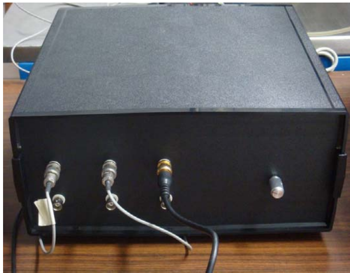
Figura 3. 10 Generador de funciones, diseñado y fabricado en el Instituto de Ingeniería
