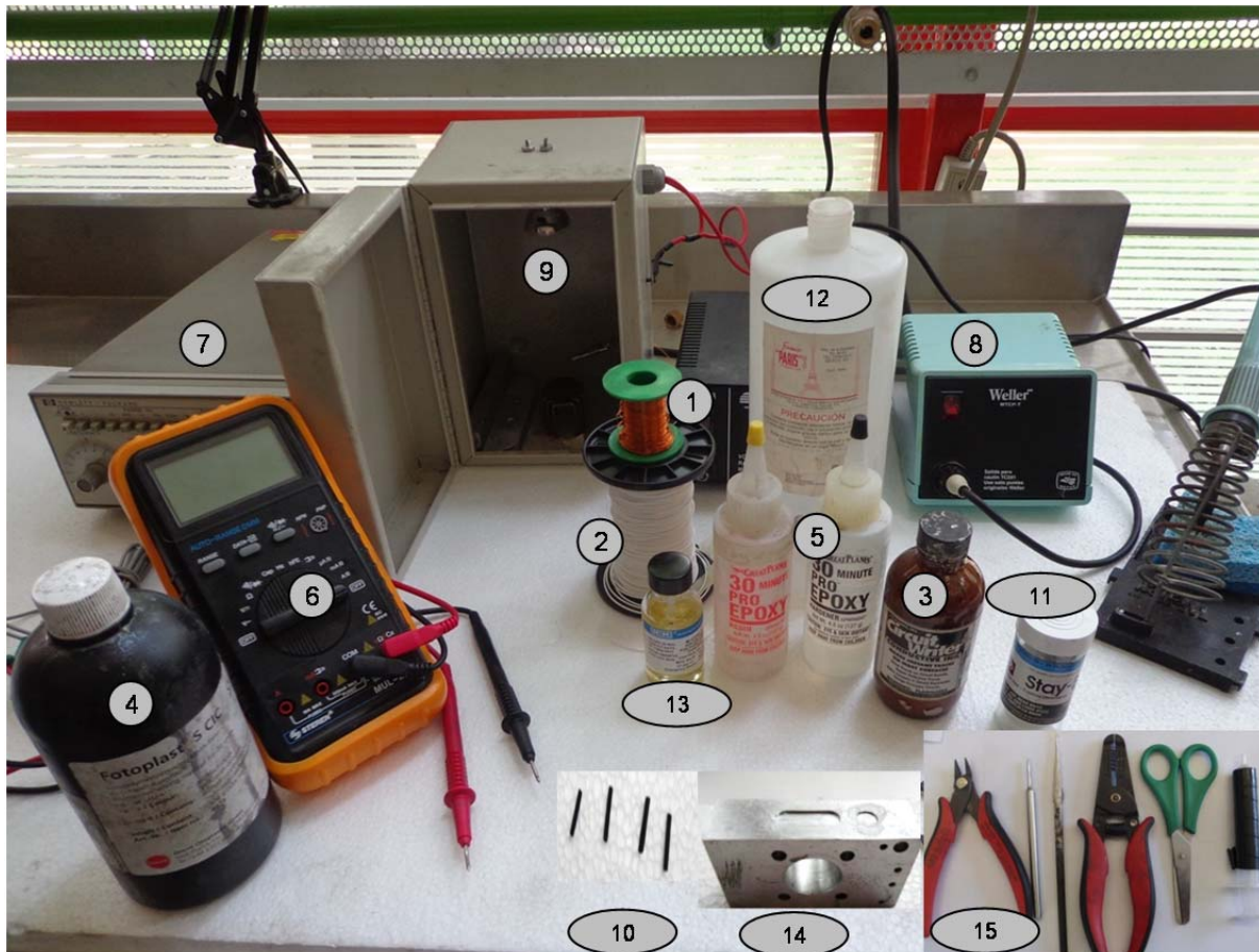
Figura A. 2 Materiales y equipo para instrumentar el cabezal y pedestal de una cámara triaxial.
