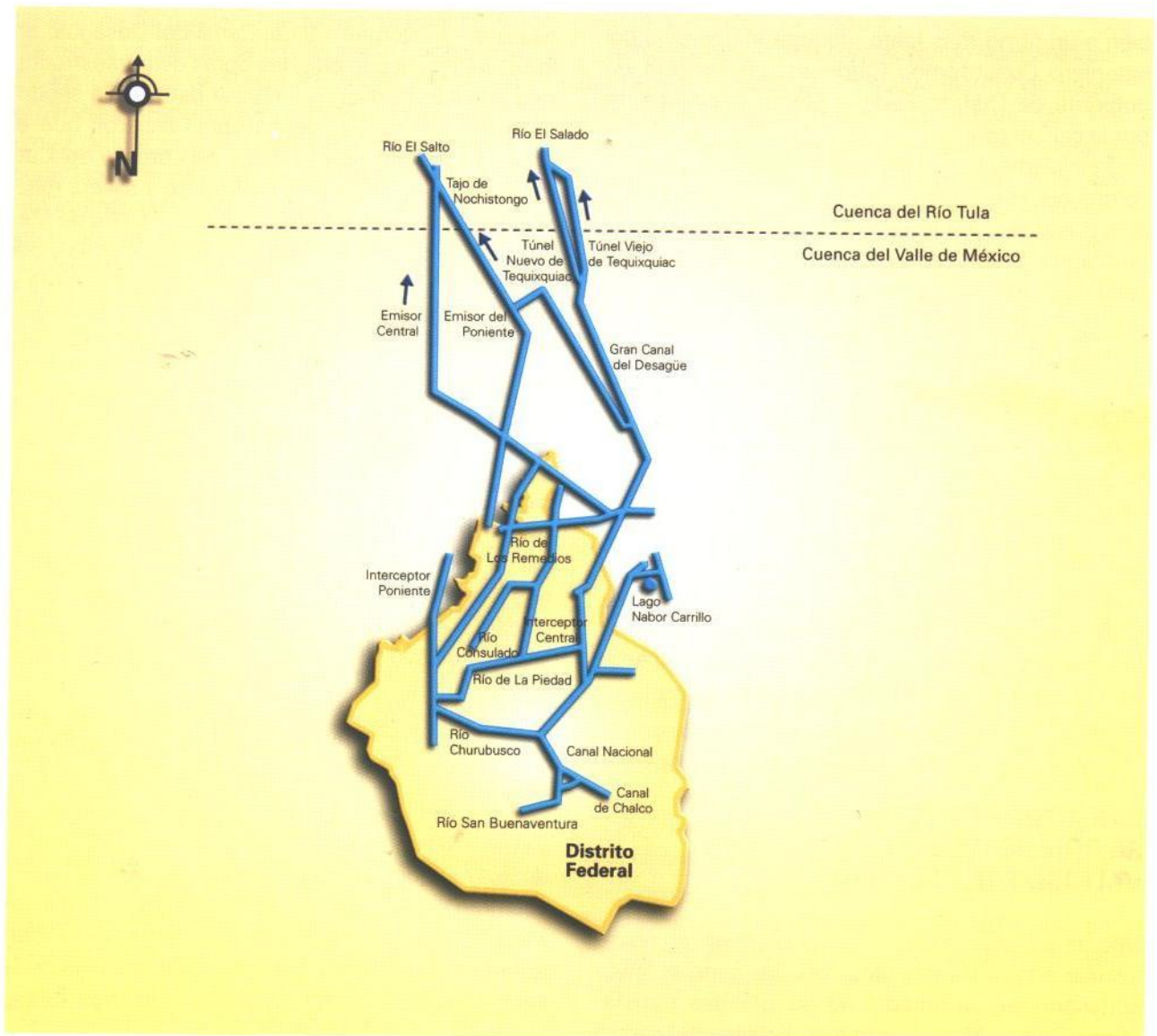
Figura A1.1 Esquema del sistema de drenaje elaborado en el año 2000.
