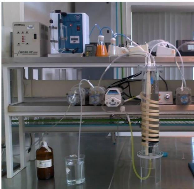
**Figura 3.5.** Biorreactor UASB utilizado para el desarrollo de la estrategia de obtención del inóculo bajo una régimen de flujo continuo.
