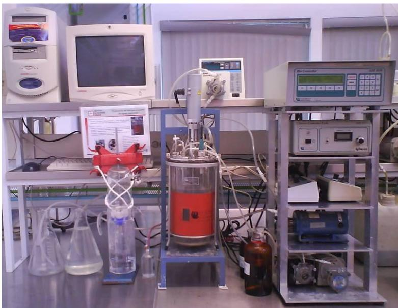
**Figura 3.2.** Biorreactor empleado para la aclimatación de la biomasa flocular.
