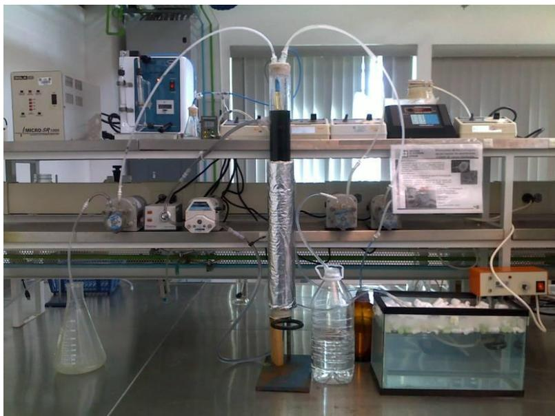
**Figura 3.4.** Biorreactor UASB utilizado para la evaluación del efecto de la alcalinidad.
