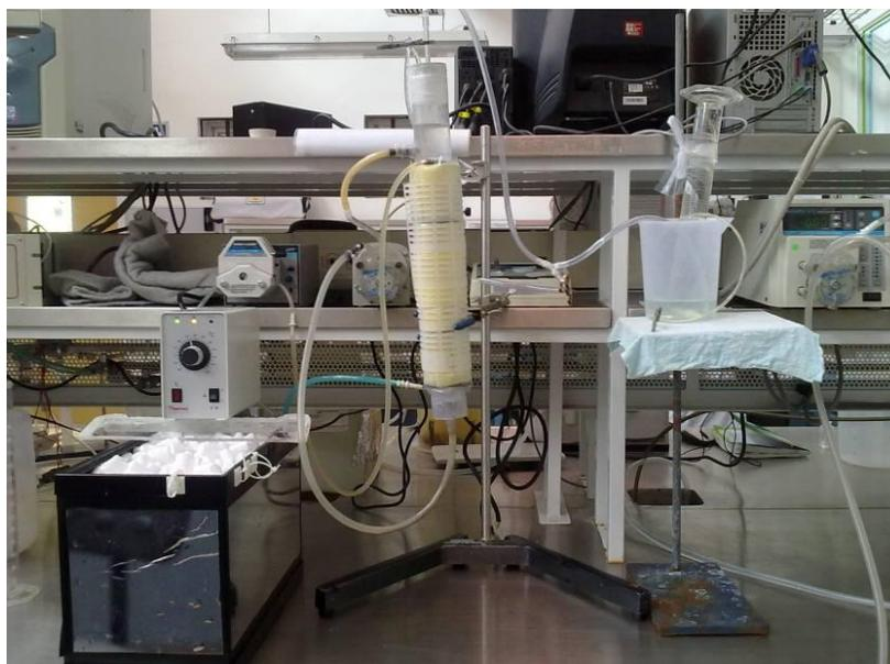
Figura 3.3. Biorreactor UASB empleado para la evaluación del efecto del pH inicial.
