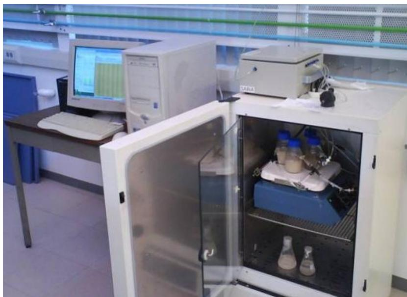
**Figura 3. 8.** Equipo empleado en las pruebas bioquímicas de producción de hidrógeno.
