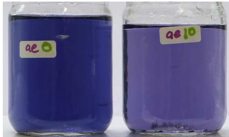
Figura 8.5 Apariencia del influente y efluente para la carga orgánica de 6.0 kgDQO d /m 3 .d
