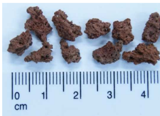
Figura 6.3 Partículas de tezontle con diámetro promedio de 4.7 mm
