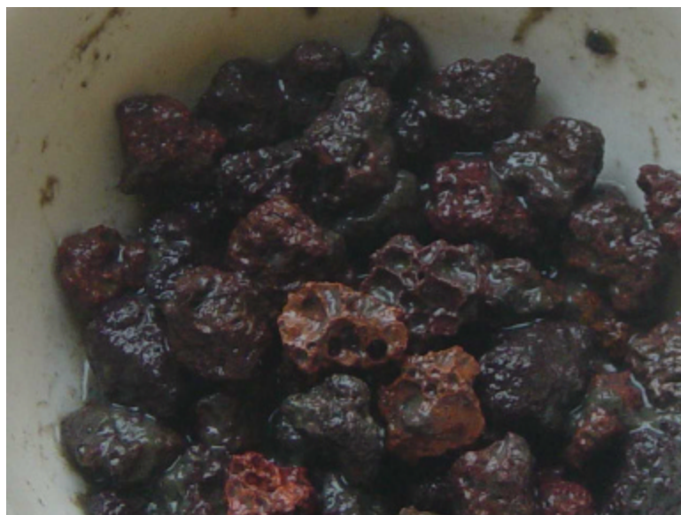
Figura 4.3. Formación de biopelícula sobre el tezontle
