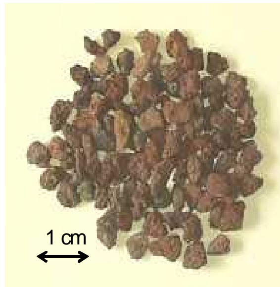
Figura 3.6. Material filtrante (soporte de la biopelícula).
