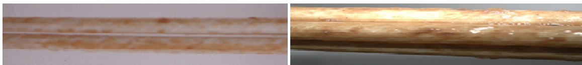
Figura 3. 21 Membrana colmatada, a) 2 semanas de operación, b) 4 semanas de operación.
