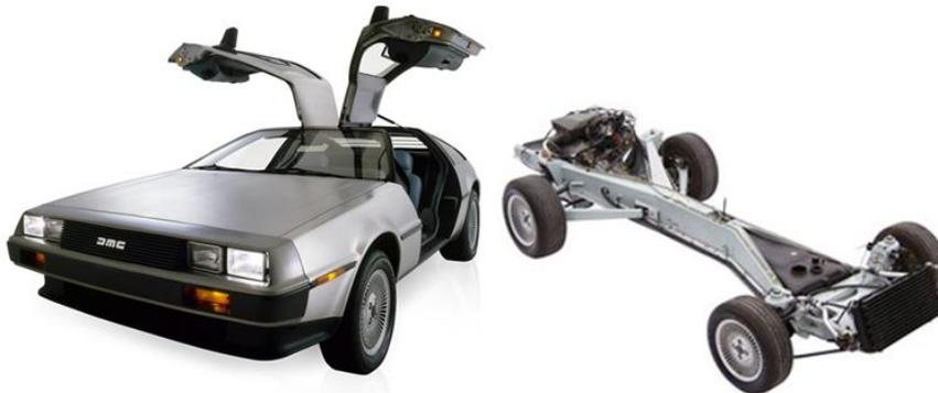
**Figura 2.2** Chasis independiente en X de un DeLorean DMC-12 de 1981.
