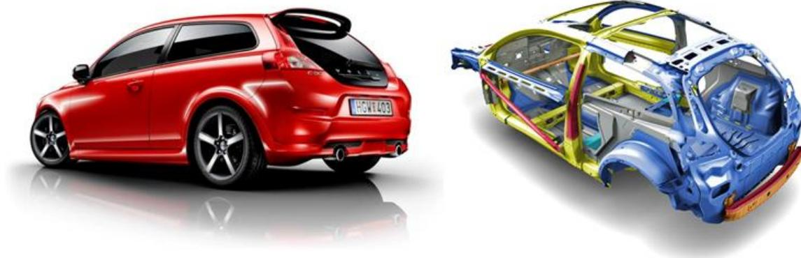
**Figura 2.4** Chasis autoportante con elementos desmontables de un Volvo C30 R-Design 2012.
