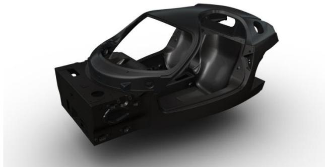
Figura 2.8 Chasis monocasco de Fibra de Carbono del prototipo Ferrari F70.
