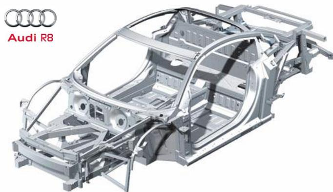
Figura 2.9 Chasis Space Frame® de un Audi R8.
