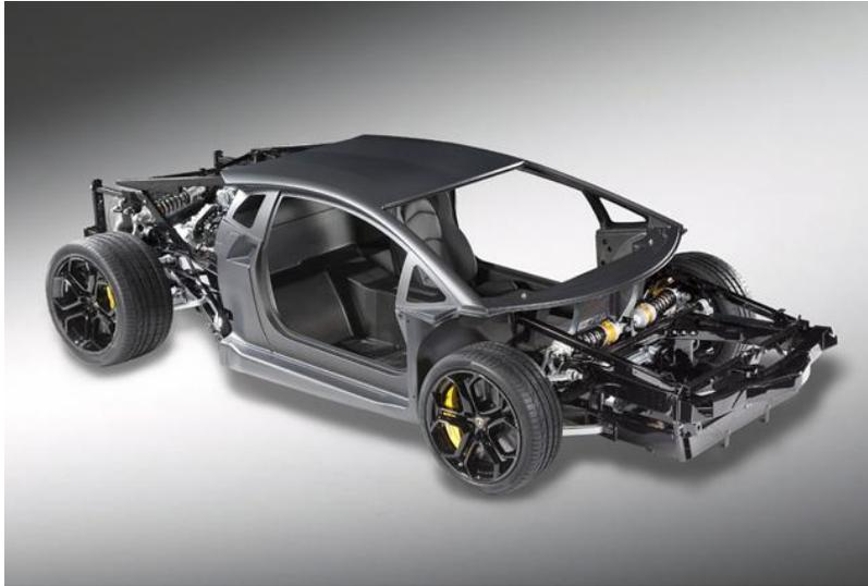
Figura 2.5 Chasis monocasco de un Lamborghini Aventador LP700-4.
