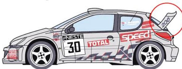
**Figura 3.1** Ejemplo del uso de apéndices aerodinámicos en un vehículo de rally.
