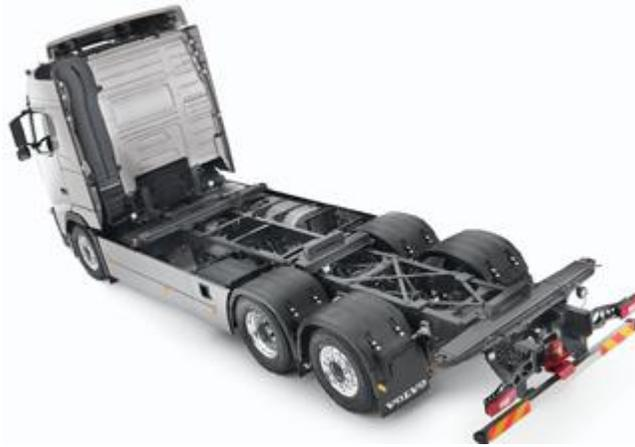
**Figura 2.1** Chasis independiente tipo escalera de un camión Volvo FH.
