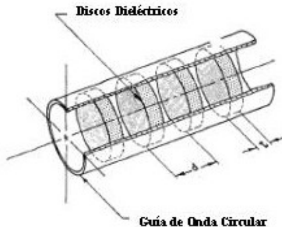
Figura 1.20: Geometría del polarizador con discos dieléctricos
