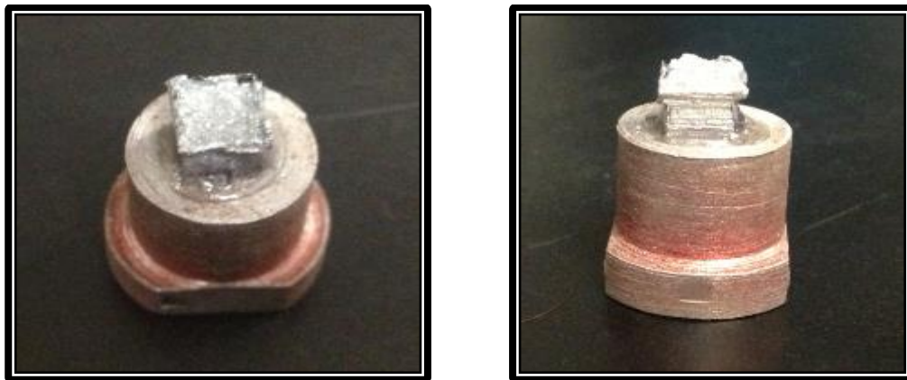
Figura 34. Detalles de las probetas montadas en la placas pegadas y el maquinado para sujetarse.
