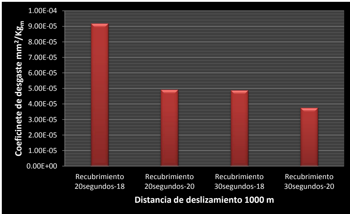
Figura 54. Conducta del Coeficiente de desgaste respecto a la distancia de deslizamiento de los recubrimientos de la Tabla 16.
