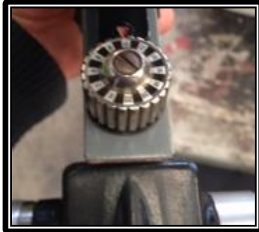
Figura 26. Sistema de apertura de boquillas número 16 y 18.
