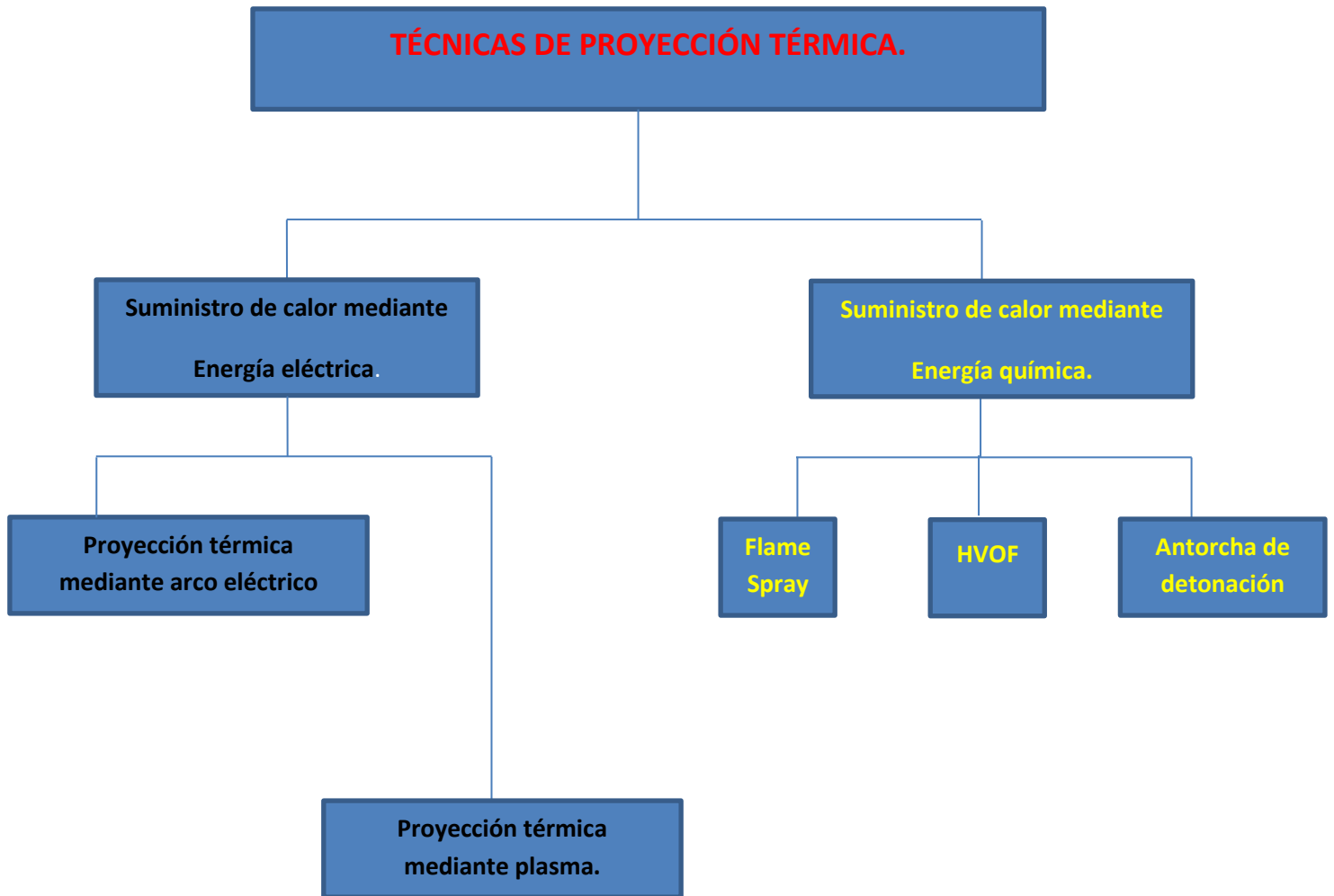
Figura 2. Clasificación de las técnicas de proyección térmica, de acuerdo a la fuente de calentamiento del material a depositar.
