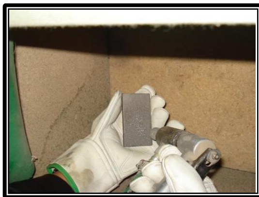
Figura 21. Proceso de granallado.
