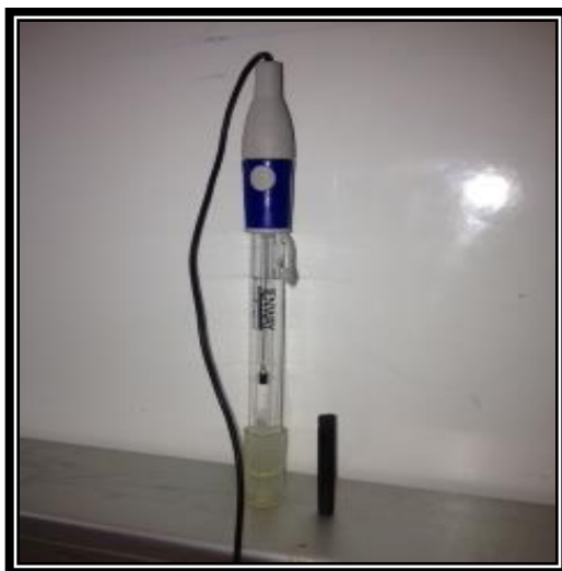
Figura 35. Electrodos utilizados para la prueba de corrosión.
