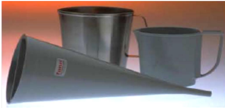
Figura 5. Embudo Marsh para medir viscosidad en campo.
