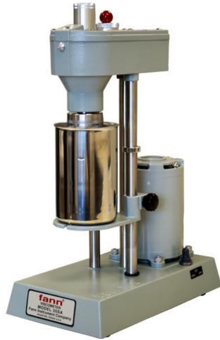
Figura 6. Viscosímetro Fann de dos velocidades (alta y baja).
