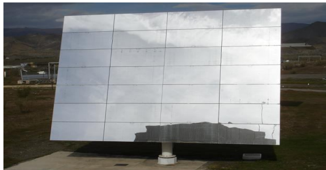
Figura 18 Helióstato con 28 facetas [17].
