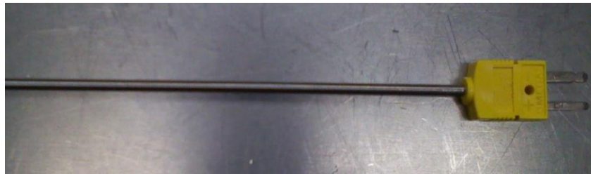
Termopar tipo K encapsulado de 1/8" de diámetro.
