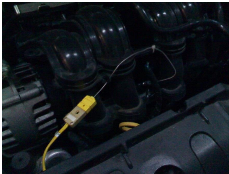
El termopar se colocó dentro del múltiple de admisión por medio de una perforación y una unión atornillada sellada.
