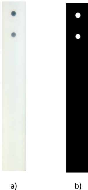
Figura 2.6..a) Imagen adquirida con cámara digital utilizada b) Imagen binarizada.
