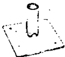
(BP) BASE PLANA, para repartir la carga sobre el piso de apoyo, de acero laminado. Peso 1.4 kg.
