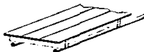
Colocación de las tarimas de madera ligera para los escalones
