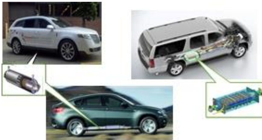
Figura 2: Prototipo de la primera generación de generadores termoeléctricos TEGs que han sido desarrollados e instalados en los vehículos Lincoln KKT (superior izquierda) y BMW X6 con un TEG cilíndrico; Suburban GM (superior derecha) con un TEG rectangular. [2]
