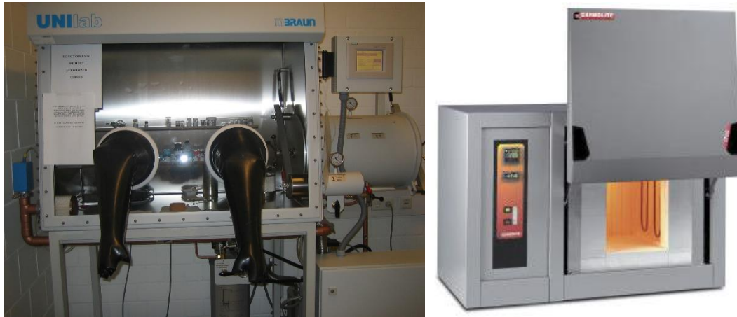
Figura 4.7: A la izquierda se muestra la cámara de atmósfera controlada, mientras que a la derecha se encuentra el horno de secado. Ambos utilizados durante el presente experimento.[1]
