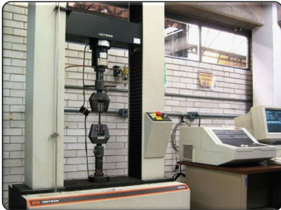
Fig. 4.2. Máquina universal de pruebas, Instron 4206. Se observa la colocación de la probeta.
