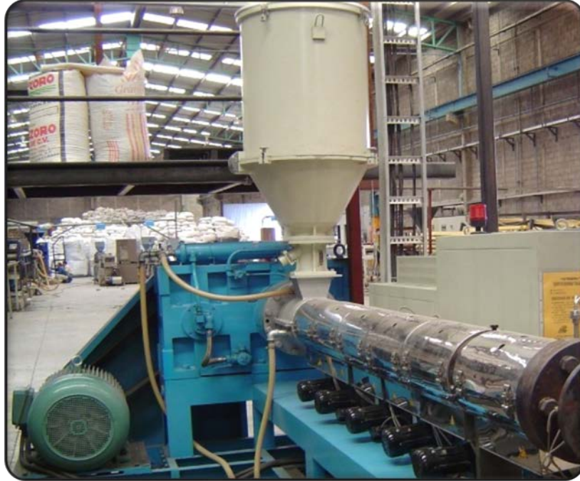
Fig. 3.1. Máquina extrusora utilizada para la obtención de los perfiles en estudio.
