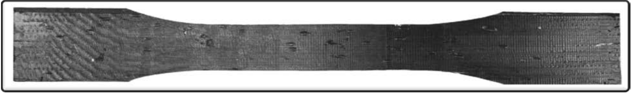
Fig. 4.1. Probeta del BLOK normalizada de acuerdo a la norma ASTM D638 .
