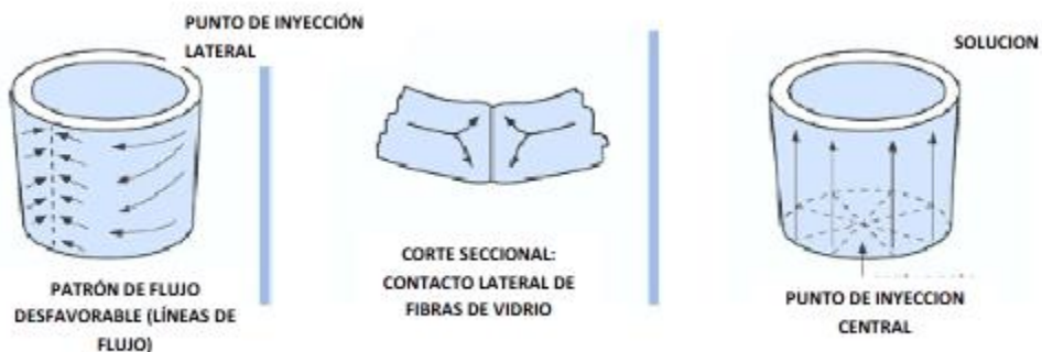
Fig. 2.24 Influencia de la localización del punto de inyección en las líneas de unión (Referencia 6).
