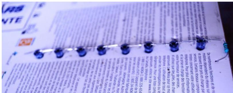
FIGURA 3.2.3 CIRCUITO PARA ILUMINACIÓN IR
