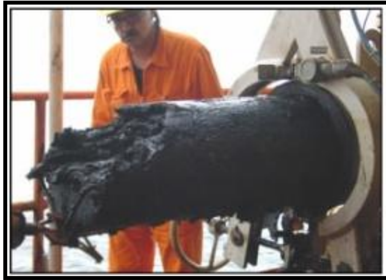
Figura 1.8 Taponamiento de la tubería por deposición de asfáltenos.
