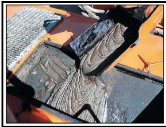
Figura 3.10 Muestra de Aceite con Arena producida mediante el Método CHOPS (Alboudwareh, H., et. al., 2006).
