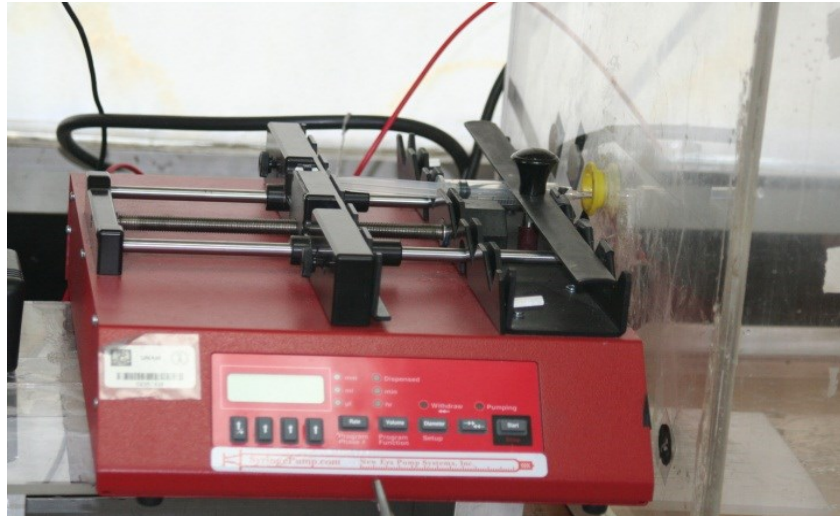
Fig. 2.3. Inyector Inyector programable usado con una jeringa montada en su parte superior, es posible observar los botones y la pantalla con la cual se programa.
