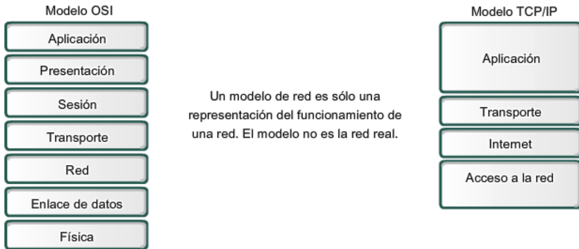
Figura 2.16. Modelos de referencia, OSI y TCP/IP.
