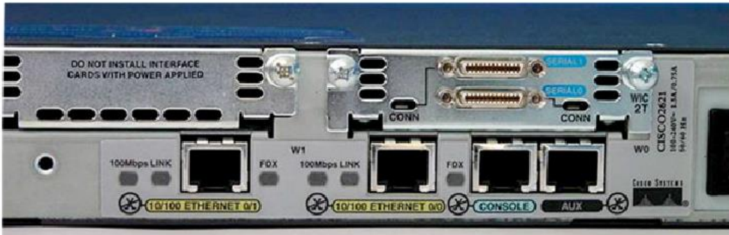
Figura 3.7. Interfaces de conexión de Enrutador Cisco Series 2900.
