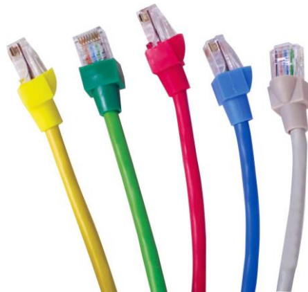
Figura 2.14. Patch cords hechos de cable UTP identificados por colores.
