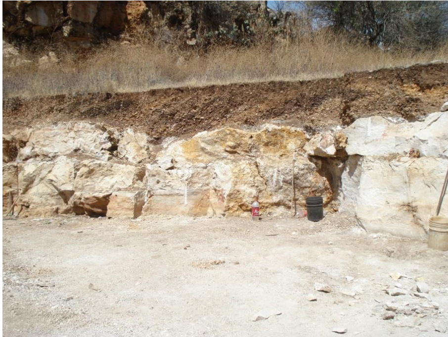
Fotografía 67: Travertino de color naranja a blanco del Pleistoceno explotado con barrena y marro.
