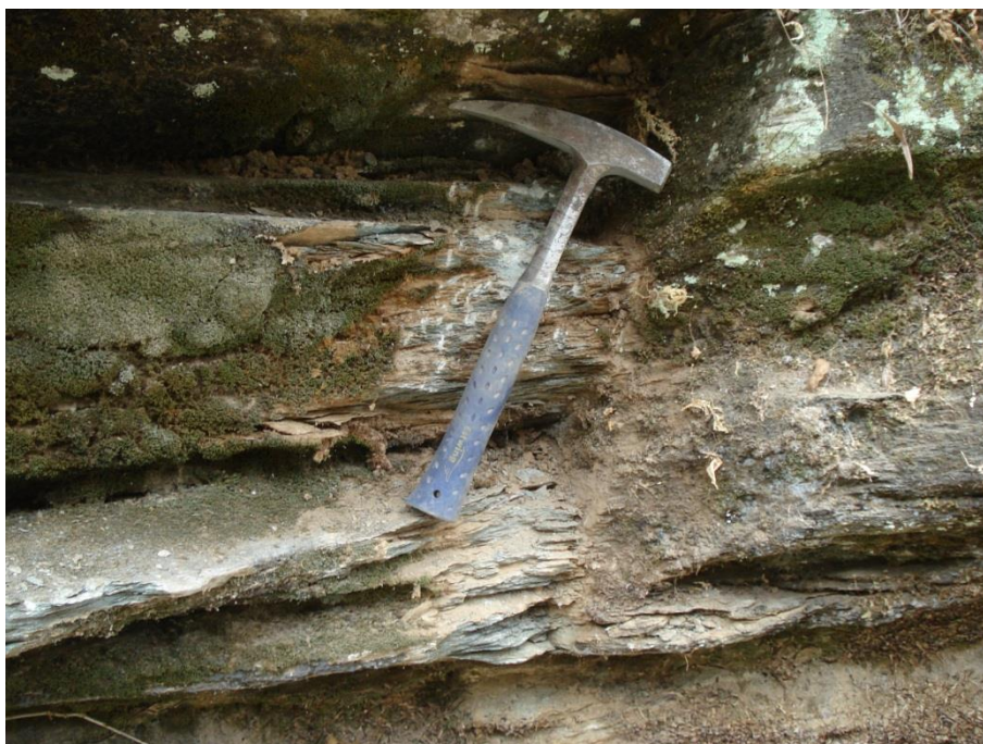
Fotografía 7: Detalle de la roca totalmente meteorizada del afloramiento de los Amates I
