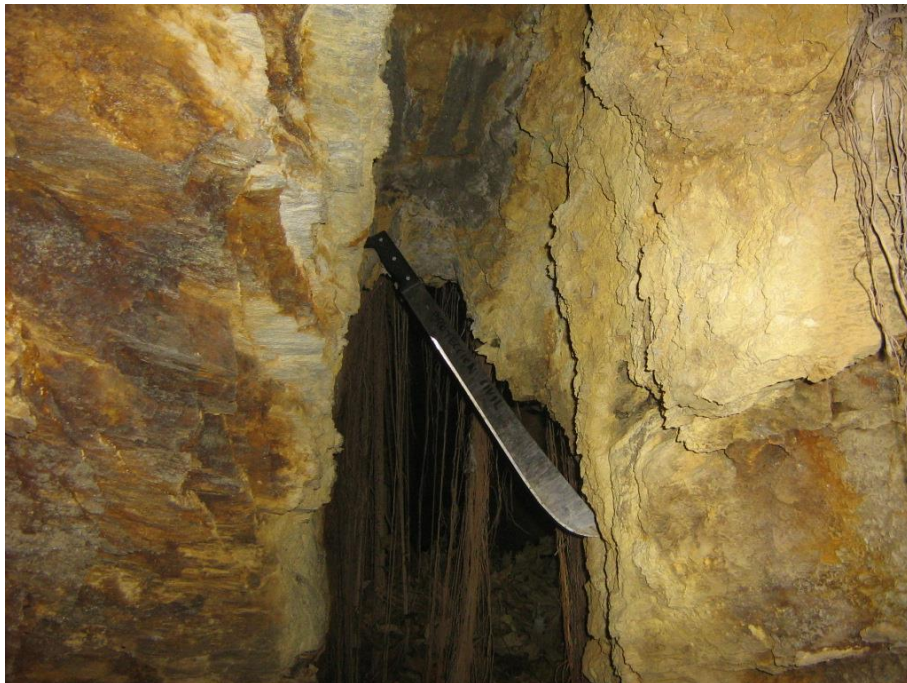
Fotografía 27: Detalle donde se observa el espesor de la veta en la parte superior, al fondo se aprecia el tiro que tiene bloqueado el paso
