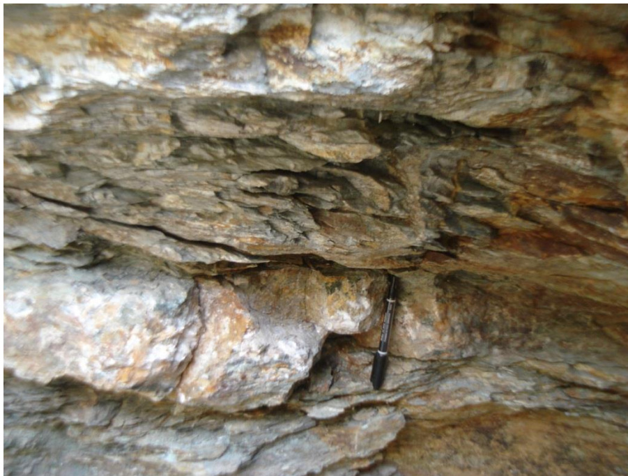
Fotografía 15: Detalle donde se observa el espesor de las vetillas de cuarzo junto con la alteración que presenta la roca encajonante.
