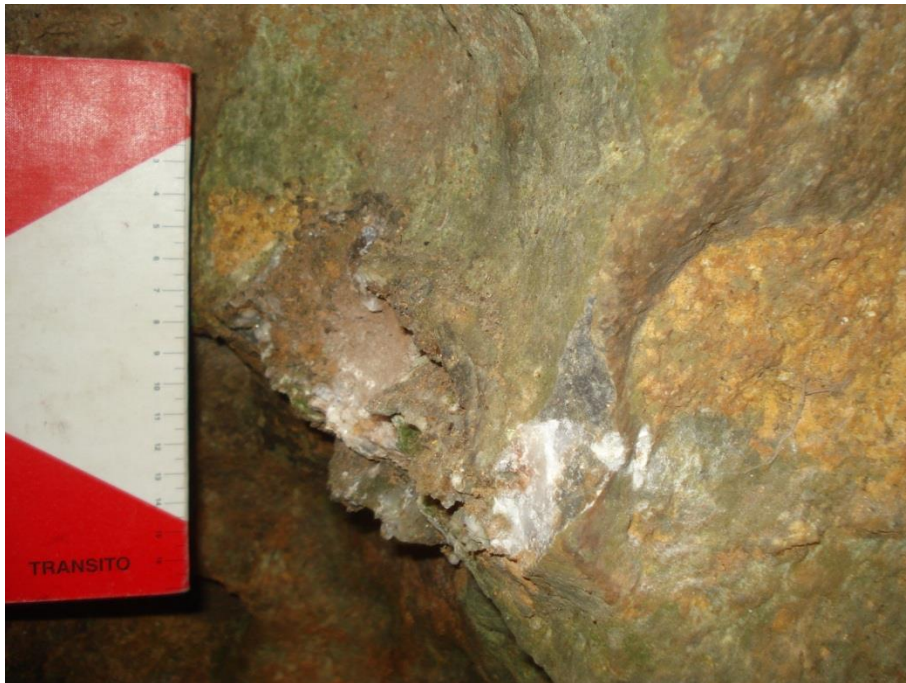
Fotografía 13: Detalle donde se aprecia la alteración que presenta la caliza cubierta con una capa de calcita.
