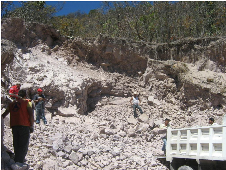
Fotografía 89: Riolita de color rosa donde se puede observar los tamaños de la roca que se pueden obtener del banco.
