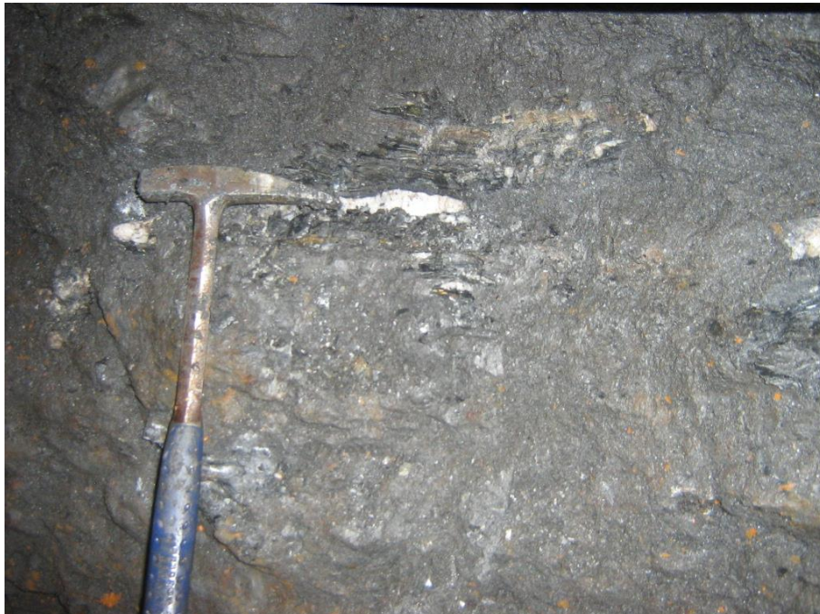
Fotografía 41: Detalle de los hilos de sulfuros que se tienen alrededor de las paredes de la mina junto con una veta de cuarzo.
