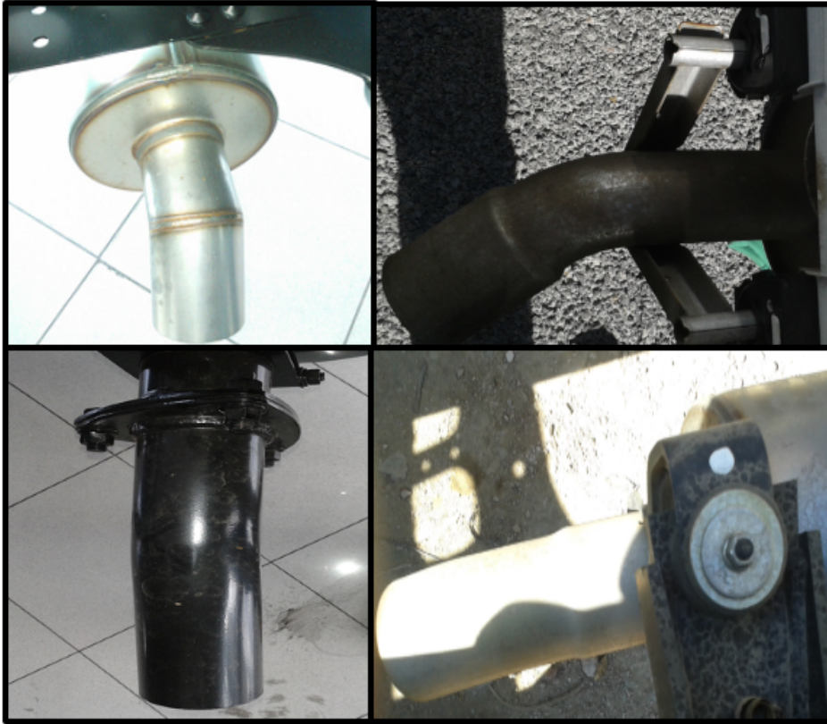
Figura 1.25 Tubos de salida.
