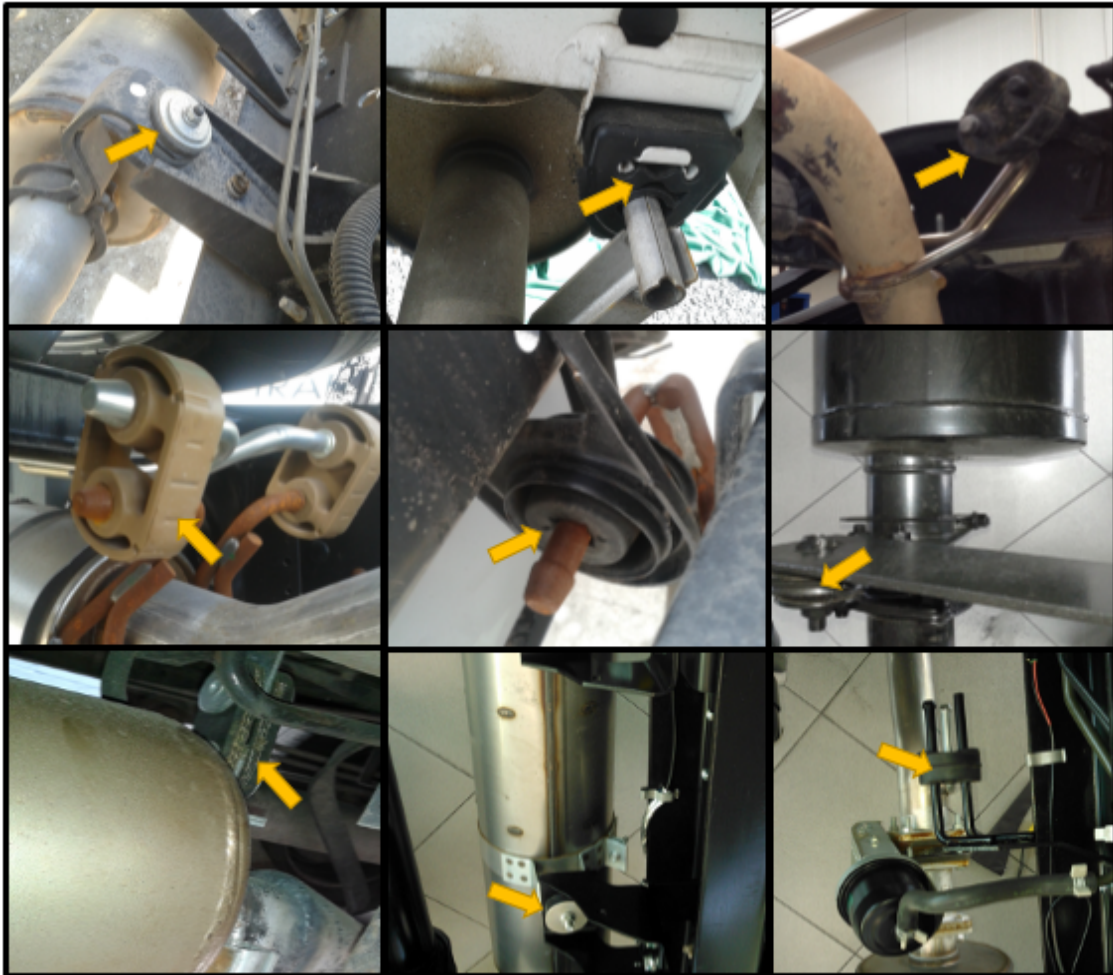
Figura 1.22 Comparativa de distintos tipos de gomas presentes en sistemas de escape.
