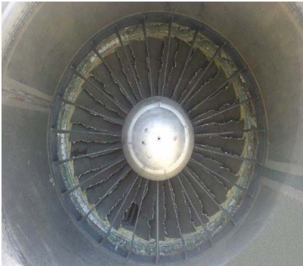
Figura 35. Daño a turbina por colisión con aves (Segundo Diplomado Internacional de planeación Interdisciplinaria Urbano Ambiental para Aeropuertos 2008)
